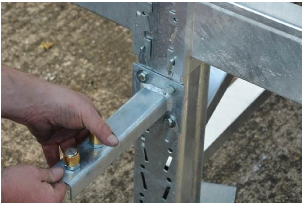
Vodící bloky upevněte šestihranným šroubem M8x30.
