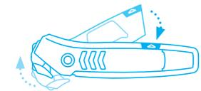
Zatlačte zásobník na čepele a zacvakněte zpět do nože tak, aby se hlavice nože vrátila do původní polohy.
