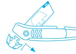
Náhradní čepel zasuňte do nože a zasuňte směrem dolů.
