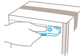
Hrot usnadňuje zabodnutí do obalového materiálu. Nepoužívejte na řezání svorek a hran krabic.
